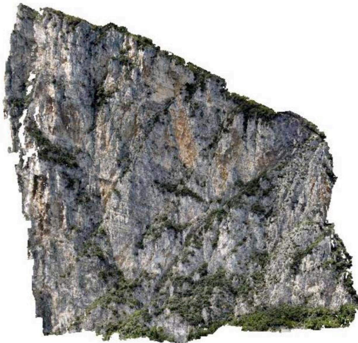
*Fig.6 Nuvola di punti risultato di elaborazione fotogrammetrica preliminare*
